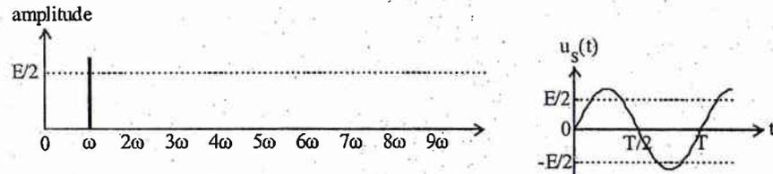
Le filtre a transformé la tension rectangulaire en tension **sinusoïdale** de valeur moyenne nulle.
