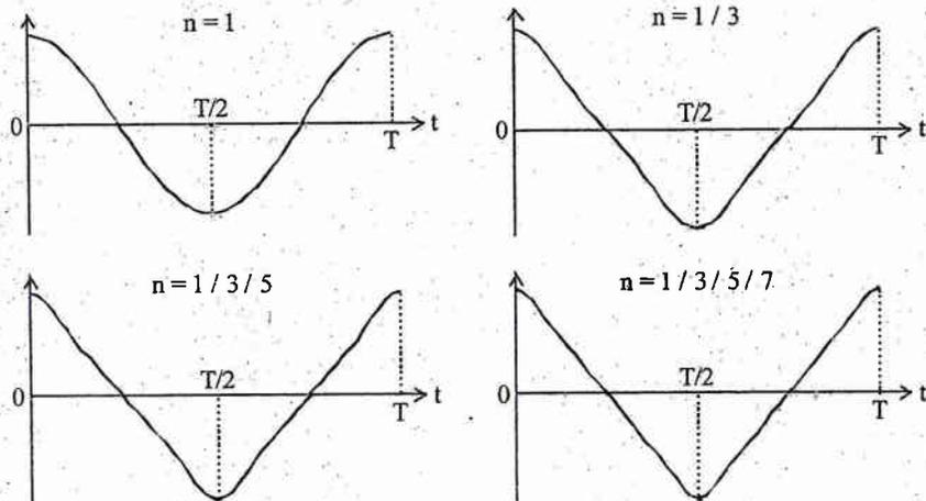
La fondamentale est purement sinusoïdale, et la tension  $u(t)$  est progressivement recomposée à mesure qu'on ajoute des contributions supplémentaires.
