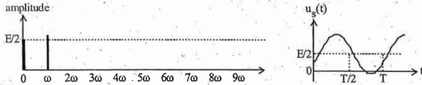
Le filtre a transformé la tension rectangulaire en tension **sinusoïdale** de valeur moyenne égale à  $E/2$ .
